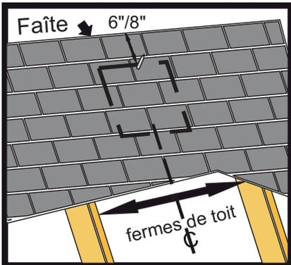
1- Positionnez entre les fermes de toit, trouvez le centre avec un clou à une distance de 6"8" (12.7/15cm) du faîte de toit. Pour une pente ( 2/12 à 8/12 =8" ) ( 8/12 à 18/12 =6" )
